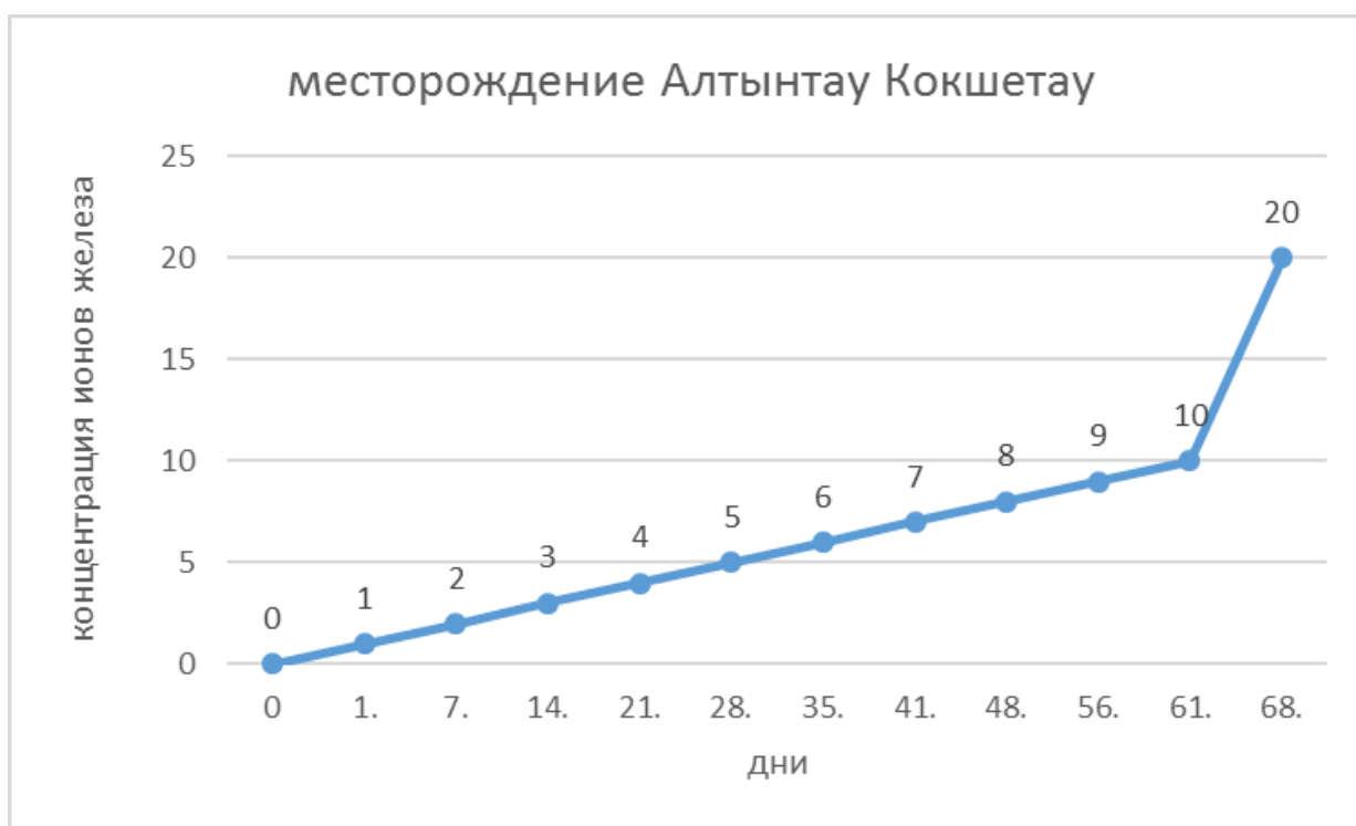
Рисунок 7 – Изменение содержания трехвалентного железа от продолжительности процесса
